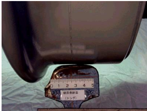
模型車輪踏面(修正円弧踏面設計形状)と 実際の摩耗レールとの接触状態
